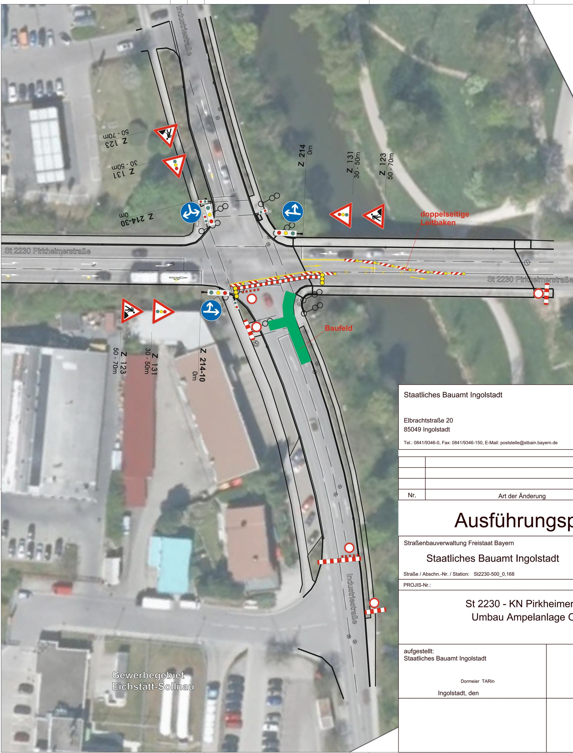
**Verkehrsregelung durch Lichtsignalanlage**
