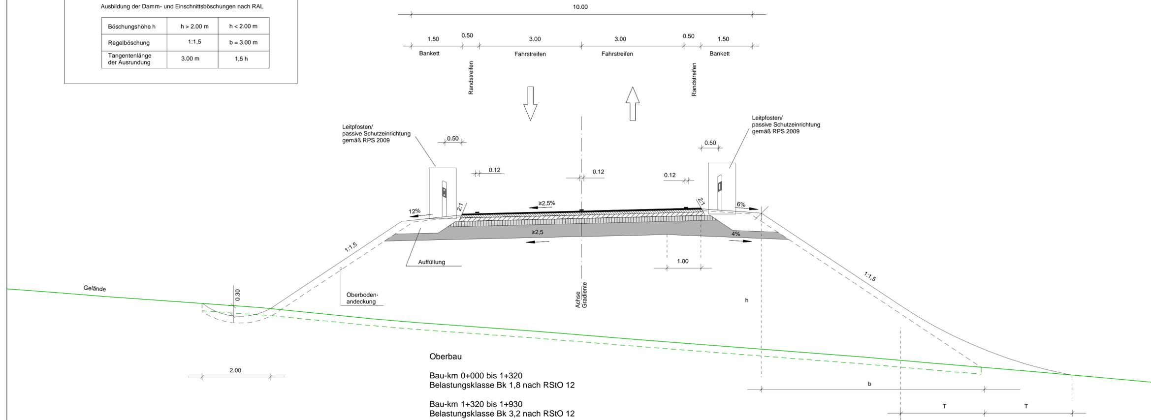
Regelquerschnitt St 2035, RQ 10 (EKL 3)
