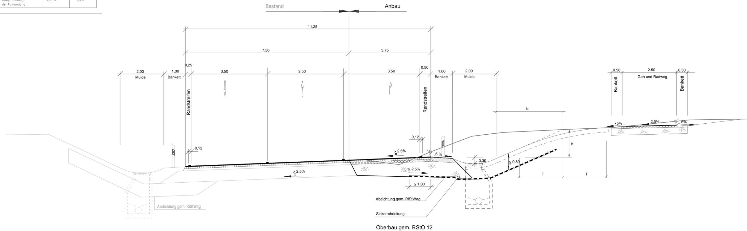
Regelquerschnitt: St 2335 - Anbau des Einfädelungstreifens
